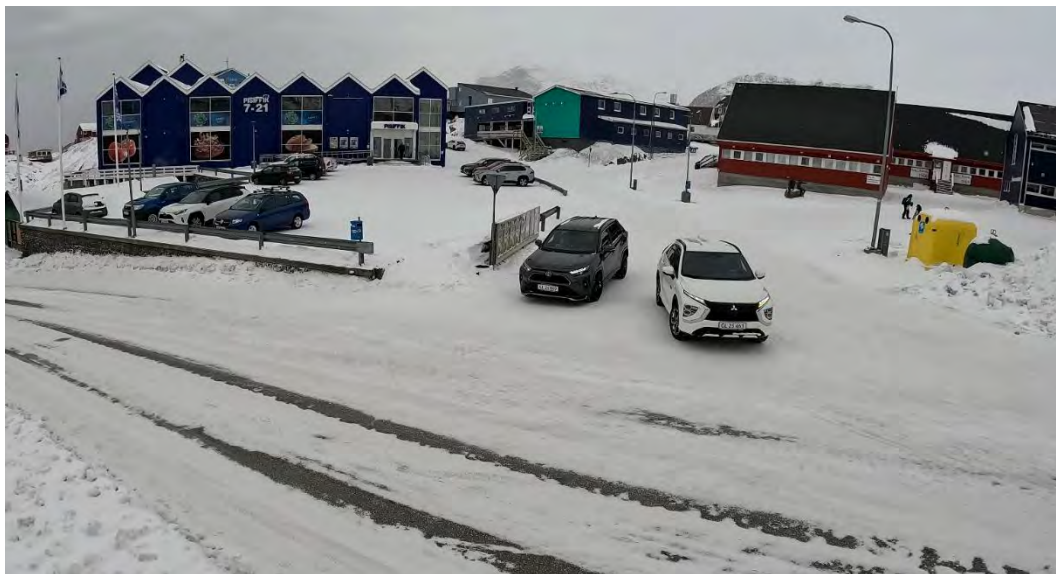
Foto 41: Kaaleeqqap Aqq. er så bred at to biler kan holde ved siden af hinanden. Dette medfører en øget uheldsrisiko. Trafikanten i den sorte bil kan fx ikke orientere sig i forhold til trafikken fra venstre da den hvide bil skygger for oversigten. Tilsvarende har den hvide bil svært ved at se til højre, hvis den ikke kører langt frem. Foto er torsdag d. 26. marts 2026 kl. 15:27.
