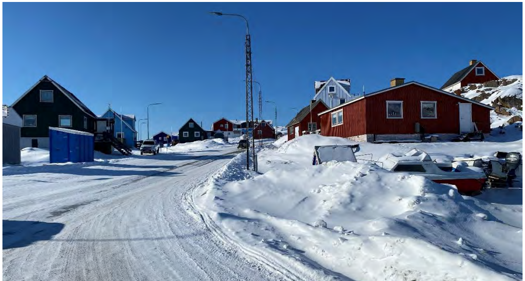
Foto 59: Oversigtsforhold er reduceret fra Glahnip Aqq. til højre mod Kaalikassaap Aqq. pga. belysningsmater, bygninger og vejens kurvede forløb.
