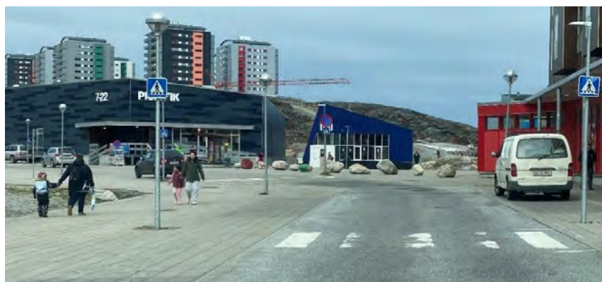
Foto 21: Eksempel fra Nuuk med kantsten som adskillelse mellem kørebane, gang, og parkeringsarealer.
