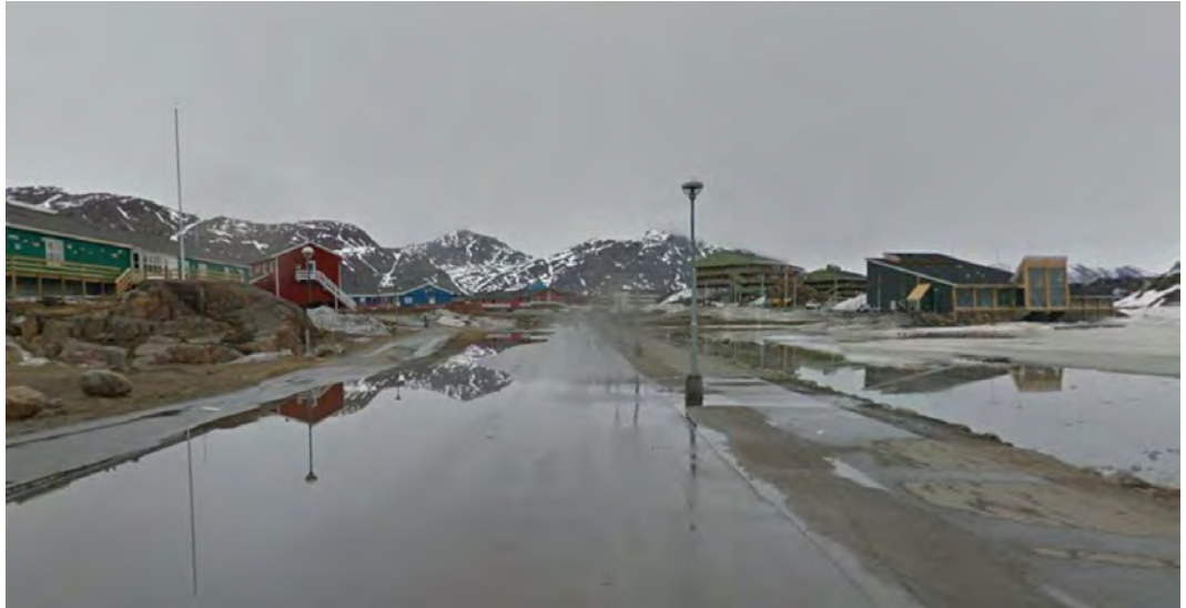
Foto 90: Der har tidligere været problemer med afvanding langs Nalunnguarfimmut ud for Spejdersøen i tøperioder. Om det stadig er et problem, vides ikke. Det kan være nødvendigt at etablere en større grøft vest for Nalunnguarfimmut, evt. en større underføring af Nalunnguarfimmut eller have større fokus på at bortkøre sneen langs Nalunnguarfimmut.
