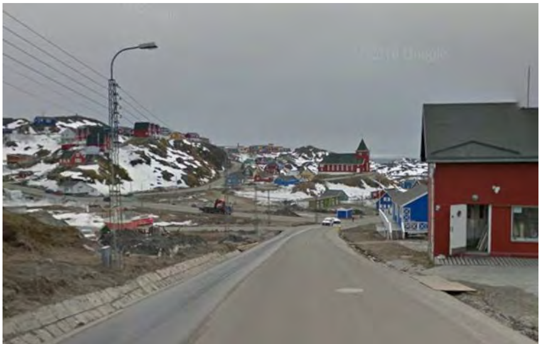
Foto 76: Aqqusinersuaq er ikke tryk at færdes langs som fodgænger. Der bør være tydelig markering af hvor fodgængerne kan færdes. Dette enten i form af en anden belægning med betonfliser eller endnu bedre bag en skillerabat/grøft.
